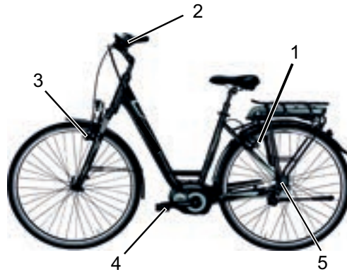
Abbildung 11: Bremssystem eines Fahrrads mit einer Rücktrittbremse, Beispiel
