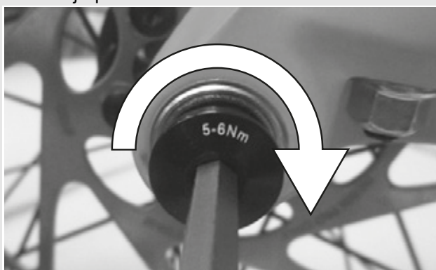
Obr. 28: Utažení pojistného šroubu
