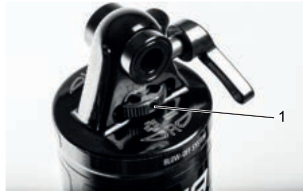
Abbildung 57: Suntour-Zugstufeneinsteller Rad (1) am Hinterbau-Dämpfer
