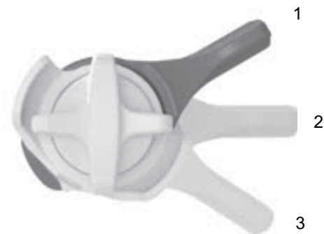
Abbildung 66: FOX-Druckstufeneinsteller am Hinterbau-Dämpfer mit den Positionen OFFEN (1), MITTEL (2) und HART (3)
