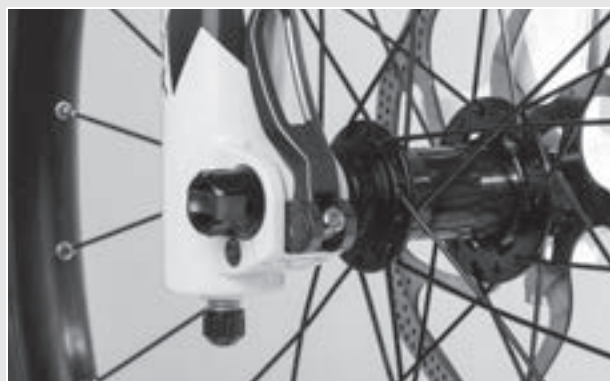
Abbildung 76: Spannkraft des Schnellspanners einstellen
