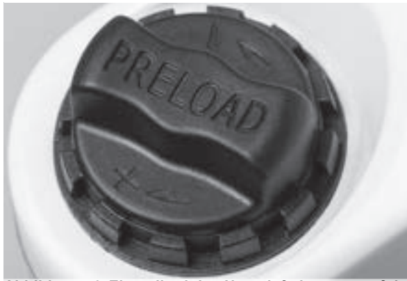
Abbildung 53: Einstellrad des Negativfederwegs auf der Krone der Federgabel
