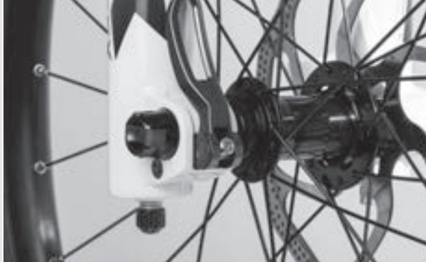
Abbildung 31: Perfekte Lage des Spannhebels
