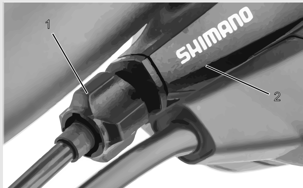
Abbildung 78: Einstellhülse (1) der einzügigen, seilzugbetätigten Gangschaltung mit Schalthebelgehäuse (2), Beispiel
