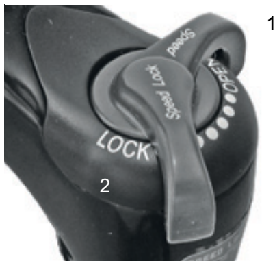
Abbildung 68: Suntour-Druckstufeneinsteller mit den Positionen OPEN (1) und LOCK (2)
