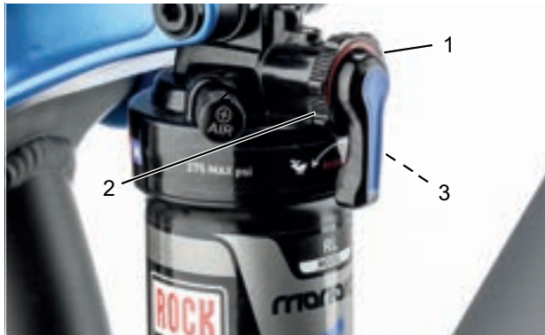
Abbildung 71: Härte des Zugstufen-Dämpfers am Einstellrad (1) des Hinterbau-Dämpfer einstellen
